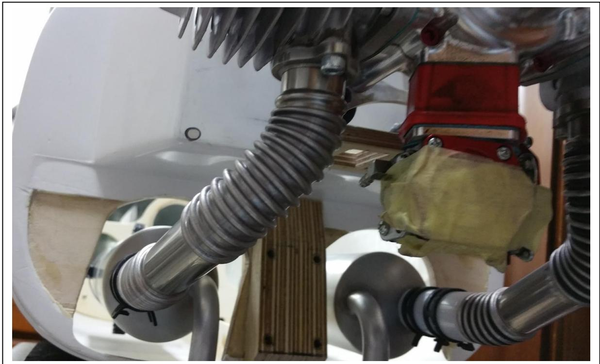
Die Krümmer werden mit O- Ringen die sich in den Rillen befinden ausgeliefert. Diese O- Ringe verhindern beim Biegen dass der Bogen nicht einfällt und die Wülste sich nicht berühren. Nach dem Biegen kann man die O- Ringe entfernen. Bitte die Krümmer nicht am Motor anschrauben und dann biegen. Die Kräfte für das Biegen sind relativ hoch und könnten ansonsten den Motor beschädigen (Stehbolzen können abreißen usw.)
