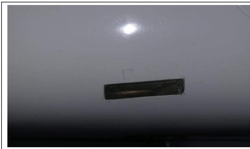
Anmerkung: ich habe nach der Fertigstellung und der exakten Schwerpunktbestimmung gemerkt dass sich das Modell gerne auf den Heckbürzel legt. Ich habe dann die Fahrwerksschenkel getauscht. Damit sitzen die Radachsen 15mm weiter hinten. Also am besten gleich die Position um 10-15mm nach hinten versetzen.
