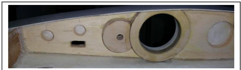
Die beiliegende GFK Hülse für das Steckrohr habe ich nicht verwendet. Zum einen ist die Aufnahme für die Flächensteckung im Rumpf super exakt, und müsste um die GFK Hülse einzukleben wieder aufgefäst werden. Damit wird die exakte Position der Tragfläche praktisch eliminiert. Als Verstärkung für die Aufnahme des Steckrohres im Rumpf reicht es völlig aus, einen Ring aus Pappelsperrholz (Super einfach mit einer Lochsäge) herzustellen, und diesen einzukleben und im Durchmesser anzupassen.
