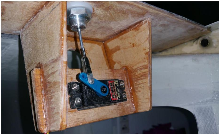
Auch bei der Servoauslegung für die Schleppkupplung gehe ich keine Kompromisse ein. Ein Digitalservo mit Metallgetriebe mit 24kg Stellkraft!
