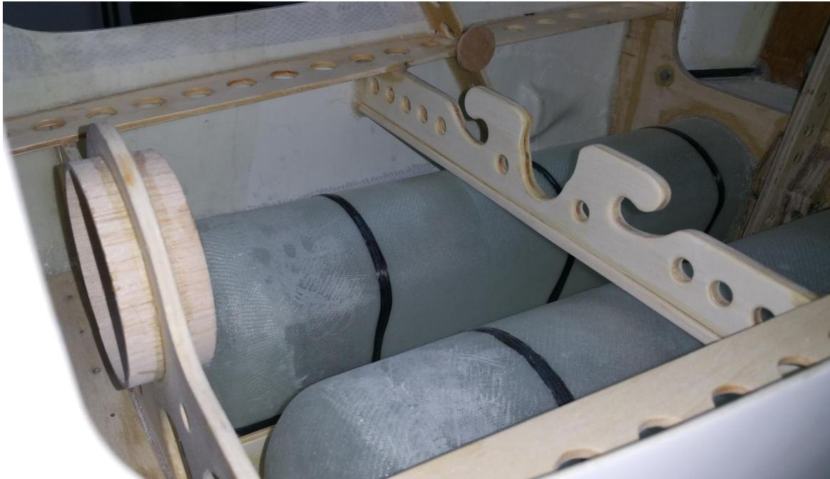
Als nächstes habe ich den Kabinenhaubendeckel mittels zweier Zentrierstifte vorne am Rumpf befestigt. Die Montage und Demontage erfolgt über diese Stifte und auf der hinteren Seite mit Kabinenhaubenverschlüsse, wie man diese auch von Seglern kennt.
