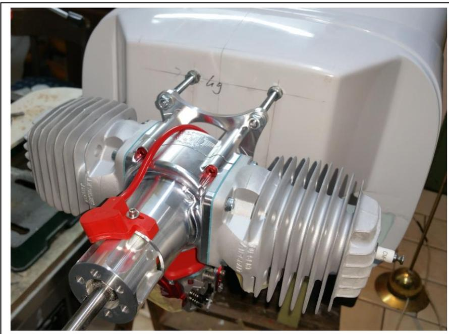
Diese Arbeit erfordert wirklich Geduld. Aber am Ende war ich froh dass der Antrieb exakt positioniert sitzt, und die Motorwelle mittig aus der Motorhaube heraus ragt.
