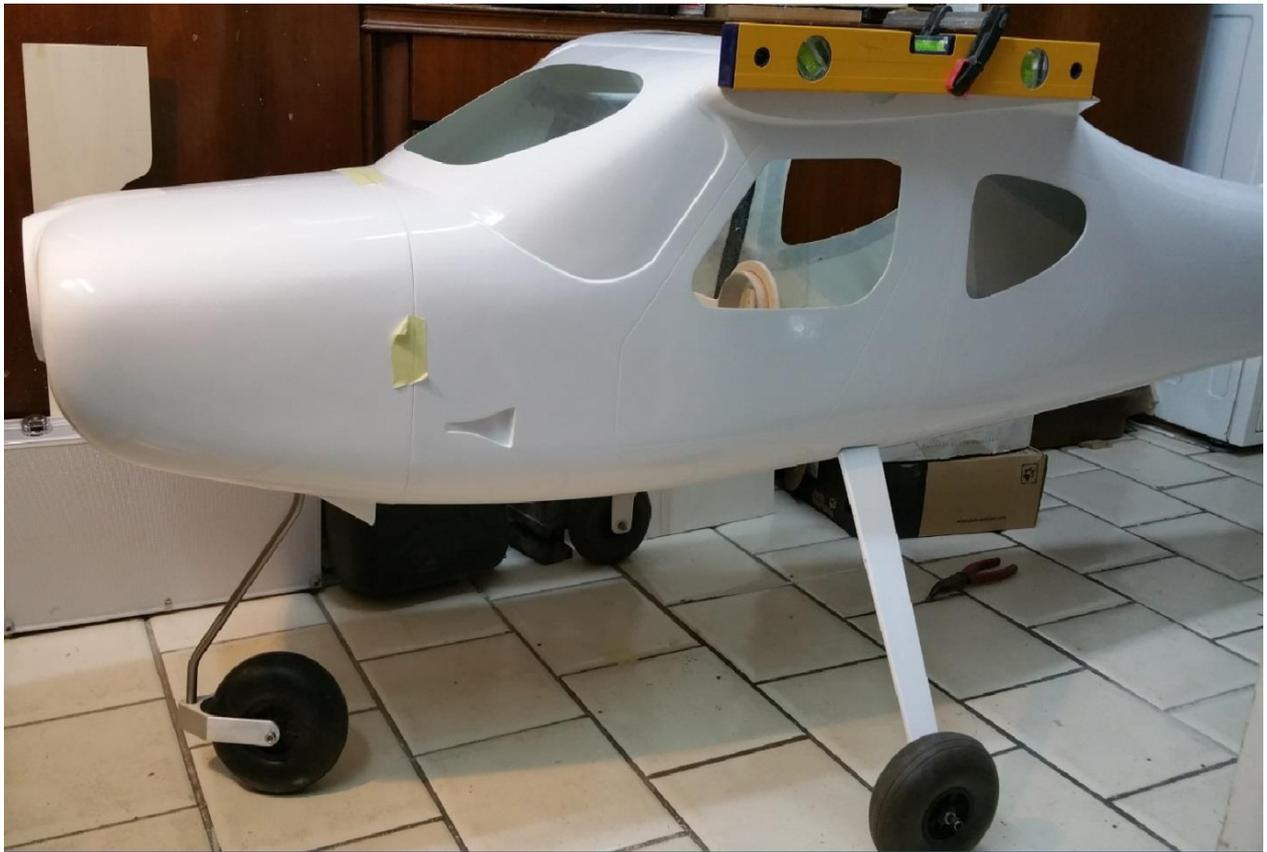
Das Bugfahrwerk hatte ich provisorisch mit kleinen Spaxschrauben auf dem Keil verschraubt. Ich wollte den Anstellwinkel der Tragflächen überprüfen. Ein negativer Anstellwinkel lässt die Glastar beim Start nicht selbstständig abheben. Ich habe einen leicht positiven Anstellwinkel gewählt (ca.  $1,5^\circ$ )
